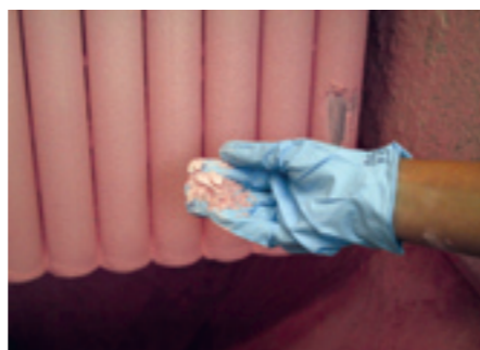
Bij het droge filtersysteem voor natlakken van Keller wordt een inerte poederlaag aangebracht op het filterelement die het vocht opneemt uit de natte overspray. Verstopping van het filter wordt op die manier voorkomen.
